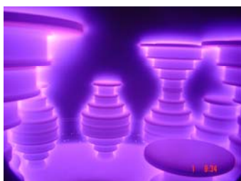
Pièces en nitruration ionique
