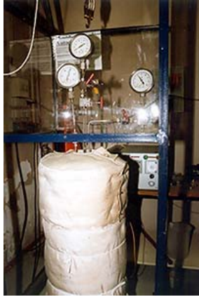
Autoclave pour essais de corrosion à chaud et sous pression
