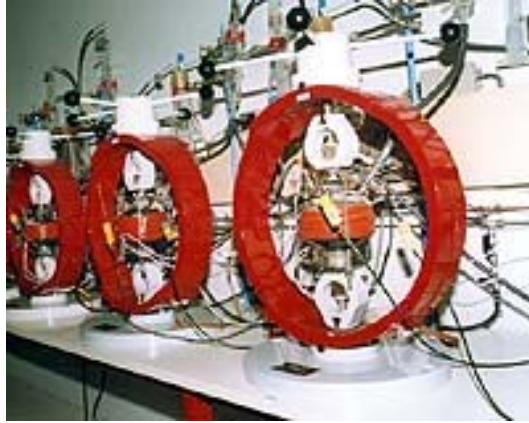
Anneaux de mise sous contrainte pour essais de traction sous charge constante en milieu corrosif
